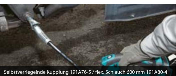
Selbstverriegelnde Kupplung 191A76-5 / flex. Schlauch 600 mm 191A80-4
