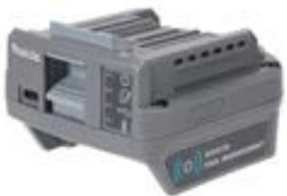
**Kommunikationsadapter zum Sperren von XGT Akkus und Maschinen.** Mithilfe dieses Adapters kann bei Makita XGT Maschinen als auch bei XGT Akkus ein Code hinterlegt werden. Diebstahlsicherung durch PIN-Kodierung. Weitere Funktionen: Auslesen von Daten (Ladezyklen, Tiefentladungen, Kapazität), Bedienung via Smartphone-App/PC.
