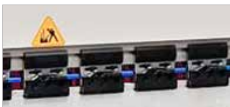
Oberwerkzeughalterung mit Schnellwechselsystem
