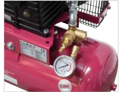
Rückschlagventil mit Last-Leerlaufventil
