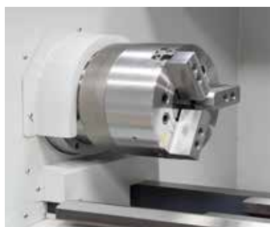
Hydraulik-Spannfutter Ø 260 mm serienmäßig
