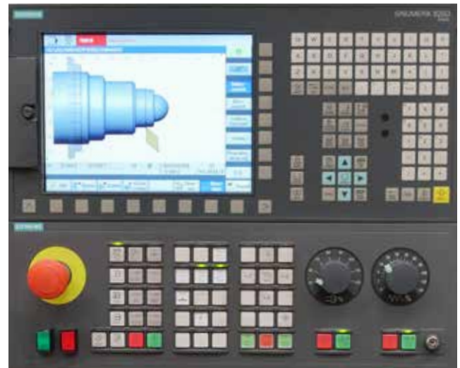
Steuerpanel mit 2 elektronischen Handrädern
