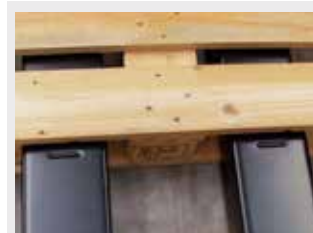
Markierung an Gabeln für optimale Positionierung des Hubwagens bei seitlichem Anheben einer Palette
