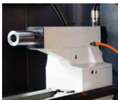
Hydraulisch betätigter Reitstock MK 4 serienmäßig
