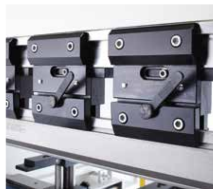
Oberwerkzeughalterung mit Schnellwechselsystem
