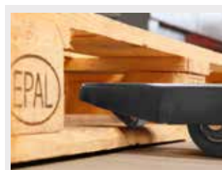
Robuster Anschlagblock an der Gabelspitze
