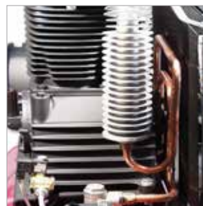
Kühler aus Alu- Druckguss und Kupferkühlleitung
