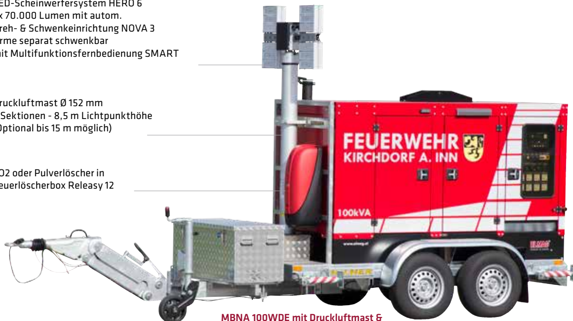
MBNA 100WDE mit Druckluftmast & Dreh- & Schwenkeinrichtung
