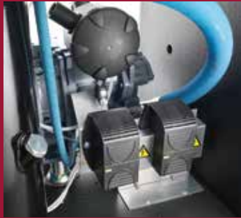
Schalldämmhauben-Heizung: Für Anlagen bei niedriger Umgebungstemperatur
