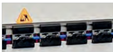
Oberwerkzeughalterung mit Schnellwechselsystem
