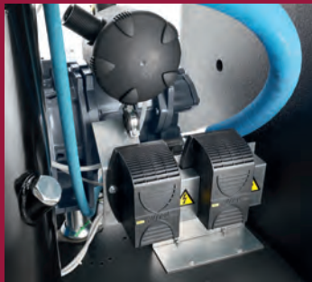
Schalldämmhauben-Heizung: Für Anlagen bei niedriger Umgebungstemperatur
