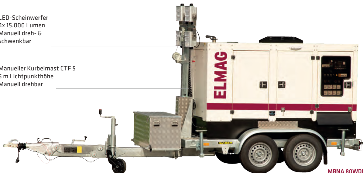
MBNA 80WDE mit manuellem Lichtmast
