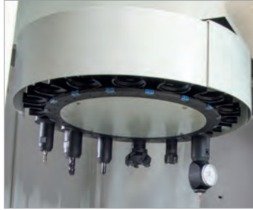
16-fach Werkzeugwechsler S 400
