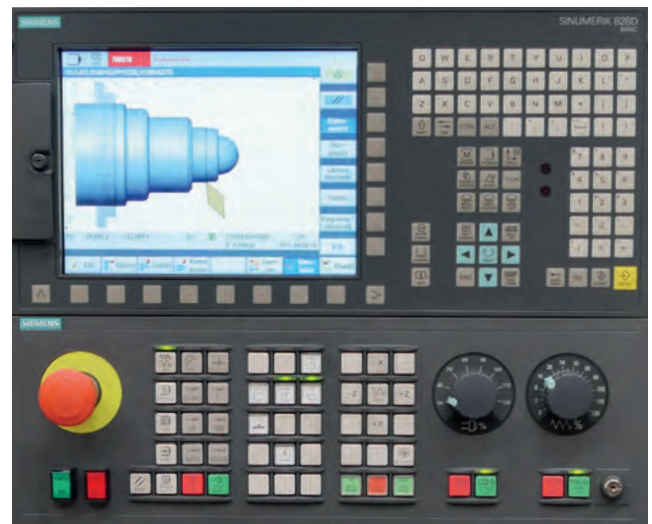
Steuerpanel mit 2 elektronischen Handrädern
