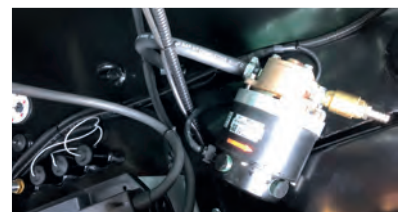
Automatische Nachtankreinrichtung aus externem Treibstofftank
